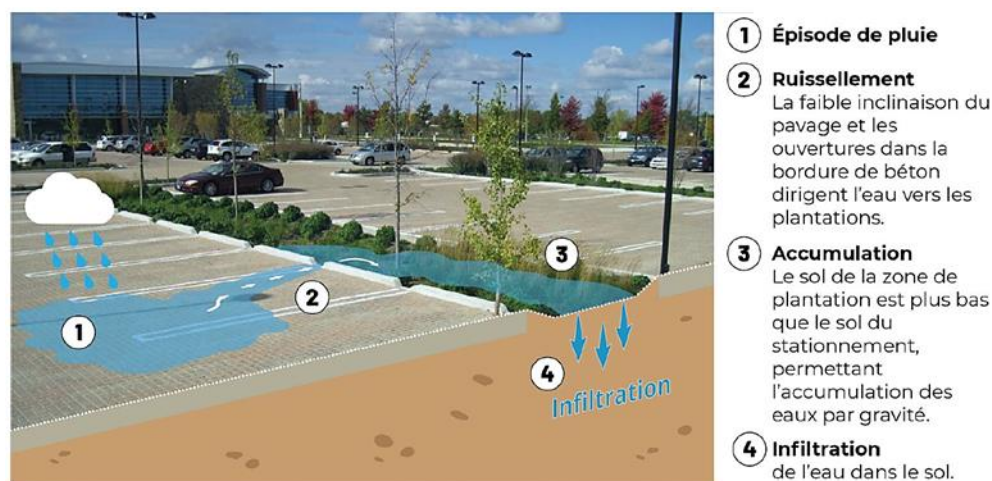
Figure 39 Bande végétalisée transformée en noue plantée d'infiltration i
